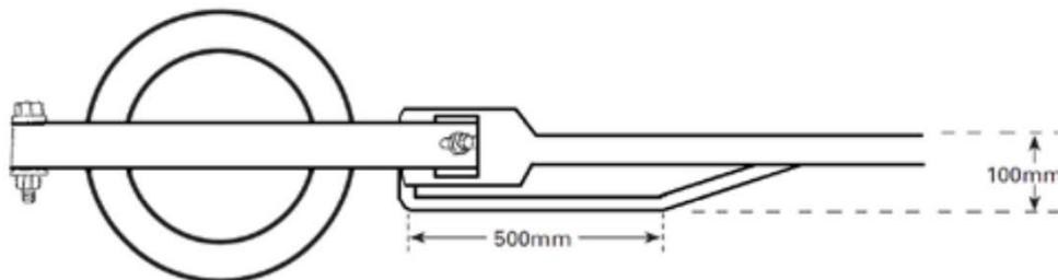
Ab 2018 Soll die seitliche Stoßstange durchgehend 100mm hoch und maximal 30mm stark sein, wie die Front und Heckstoßstange.
