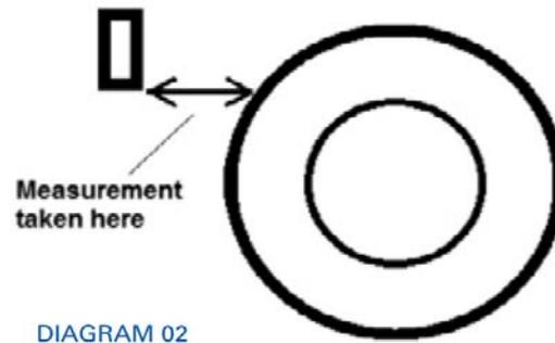
Die hintere Stoßstange darf maximal 300mm vom Reifen entfernt sein.
