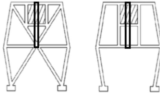
Im Fußraum muss eine Bodenplatte mit einer Stärke von 3mm fix verschweißt sein mit beiden Seiten Rohre.
