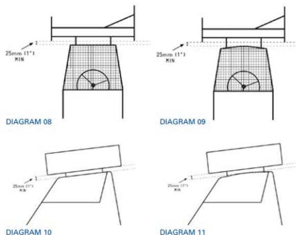
Der Motor muss sich Zentral in der Karosserie befinden. Gemessen wird zwischen den zwei Hauptrohren zur Kurbelwellen Mitte +/- 25mm
